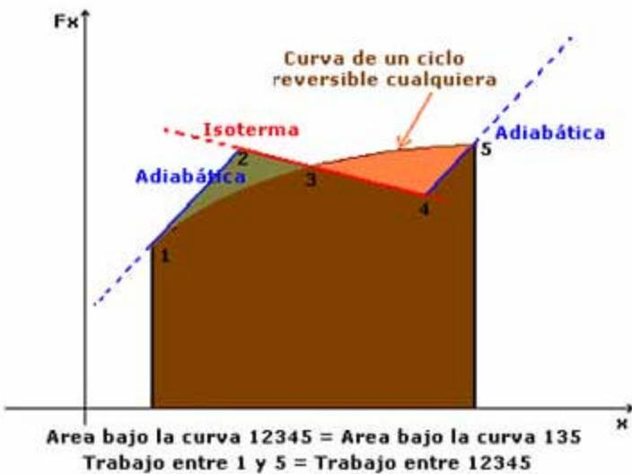
Se tiene, entonces, que  $\Delta W_{12345} = \Delta W_{15}$ , y, de acuerdo con el Primer Principio de la Termodinámica, es  $\Delta Q_{12345} - \Delta W_{12345} = \Delta Q_{15} - \Delta W_{15} \Rightarrow \Delta Q_{12345} = \Delta Q_{15}$ .
