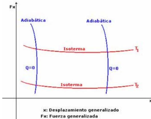
El trabajo realizado a lo largo de un tramo cualquiera comprendido entre dos puntos A y B del mismo es el área comprendida bajo la gráfica correspondiente del tramo y que lo da la integral correspondiente de la fuerza generalizada por la diferencial del desplazamiento generalizado
