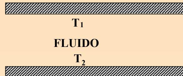
$T_1 > T_2$  : estratificación: conducción
